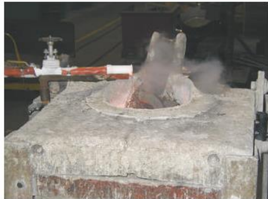
图 8-5 液氩或液氮通过喷嘴滴进熔池
